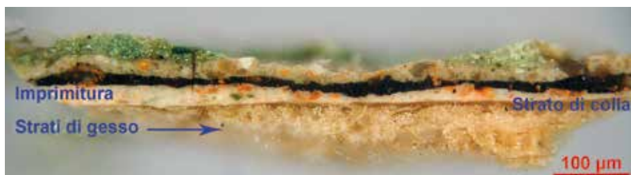
Fig. 6 - Foglia dell'alberello. Sezione microstratigrafica lucida del campione.
