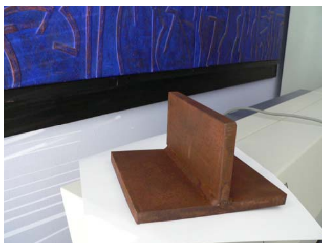
CAMPIONE – Lamiera forata "su disegno" in corten, per ottenere una superficie antiscivolo sulle superfici calpestabili
