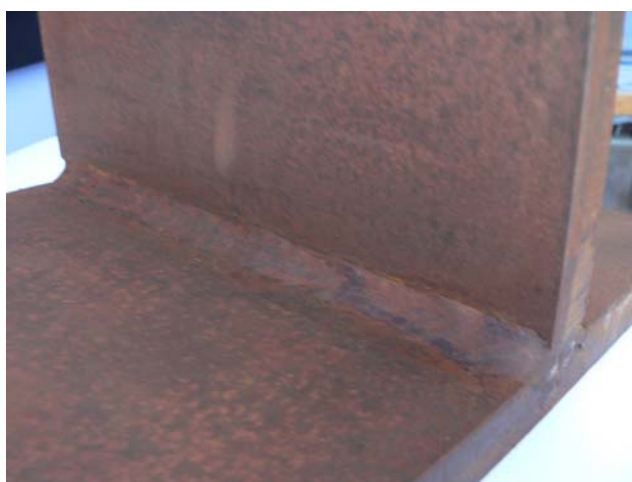
CAMPIONE – Lamiere da 15 mm in corten – Particolare della saldatura (l'utilizzo di elettrodi al 2% o al 3% Ni nelle ultime due passate permette di ottenere cordoni di saldatura con una colorazione simile a quella dell'acciaio corten)
